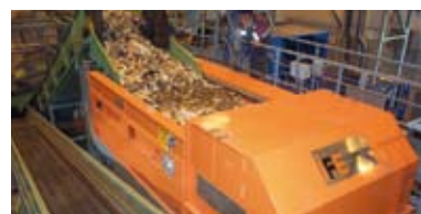
Wirbelstromscheider zur Entfernung von NE-Metallen Eddy current separator - to separate nonferrous materials
